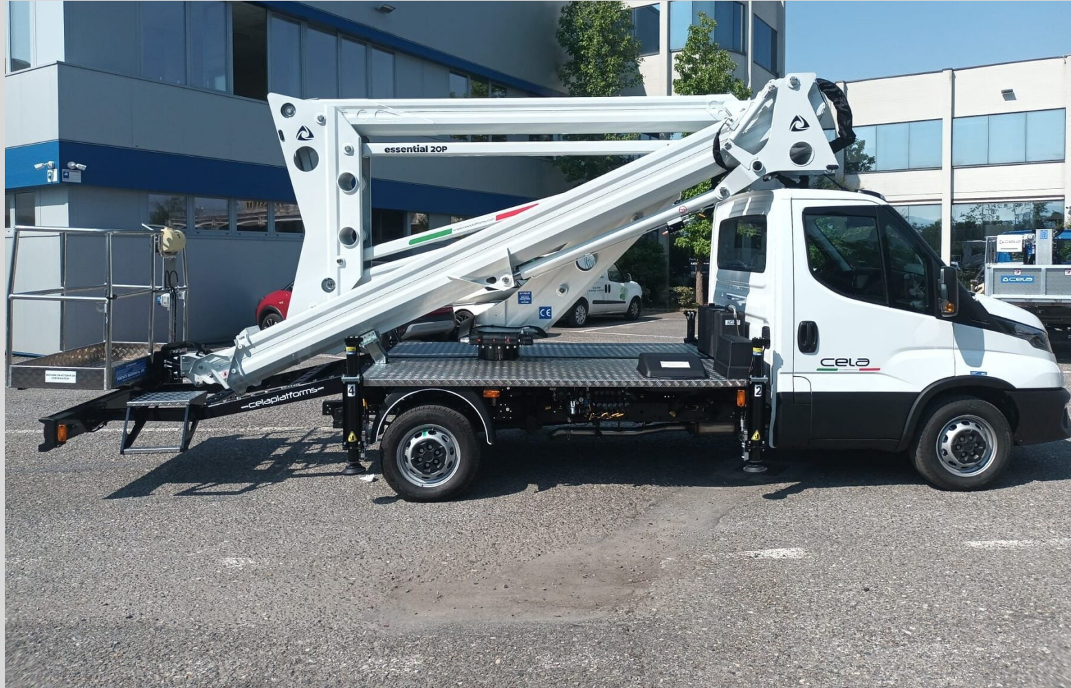
Cela Essential 20P: بانتوغراف مزدوج لتجاوز العوائق على الواجهات، بارتفاع تجاوز (up-and-over) يبلغ 9.5 m / 31 ft
