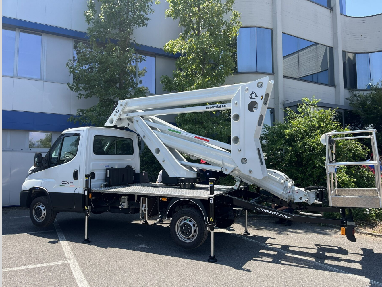
Cela Essential 24P: ارتفاع عمل 24 m / 79 ft على شاحنة 3.5 t تُقاد برخصة قيادة السيارات
