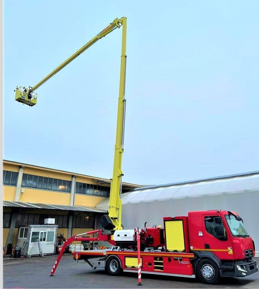
هندسة مكافحة الحرائق، 3 في 1: منصة إطفاء مجنزرة تحملها شاحنة، تعملان معاً أو كلٌّ على حدة
