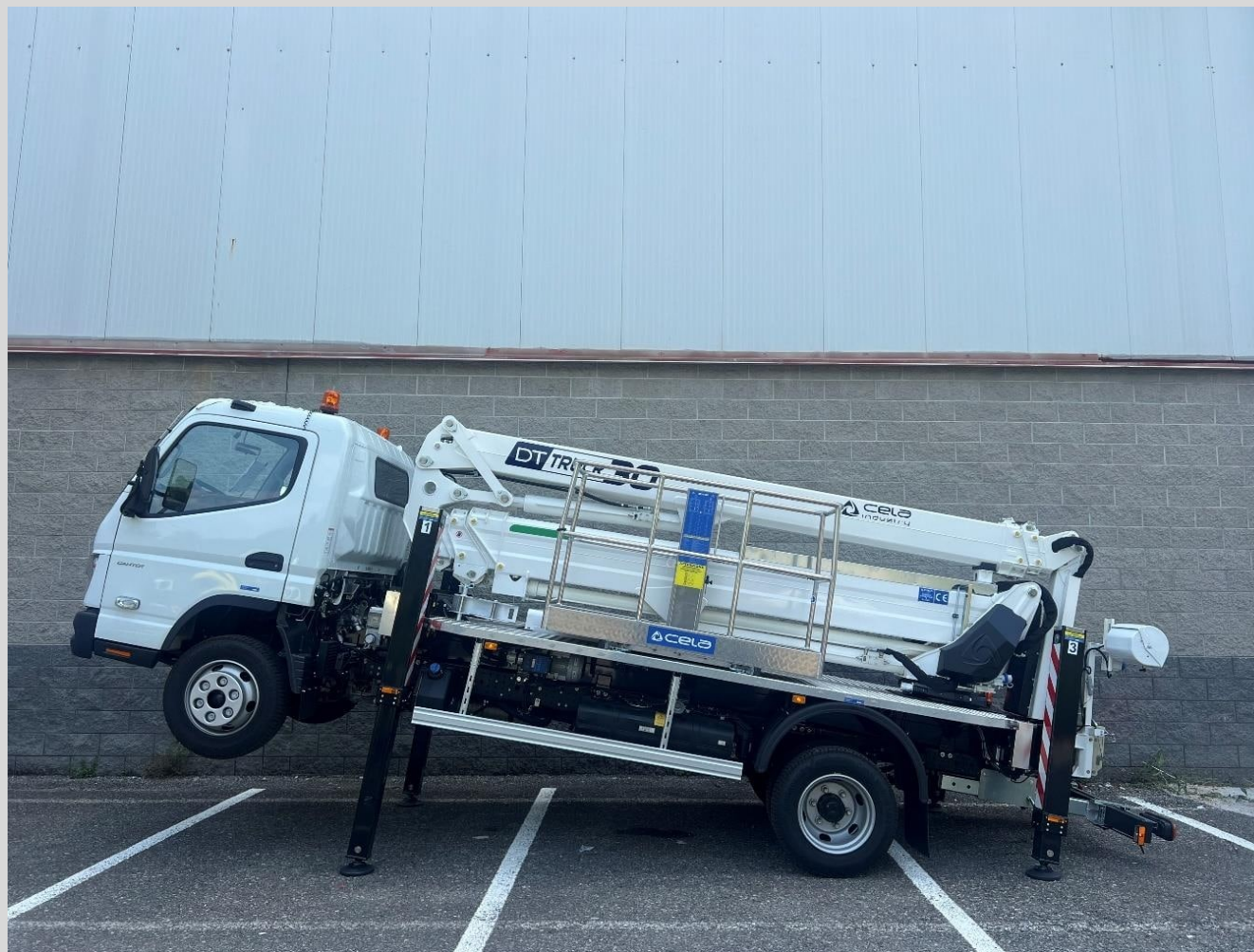
ركائز التثبيت الصندوقية تتيح لمنصة DT Truck 30 التثبيت على المنحدرات الشديدة
