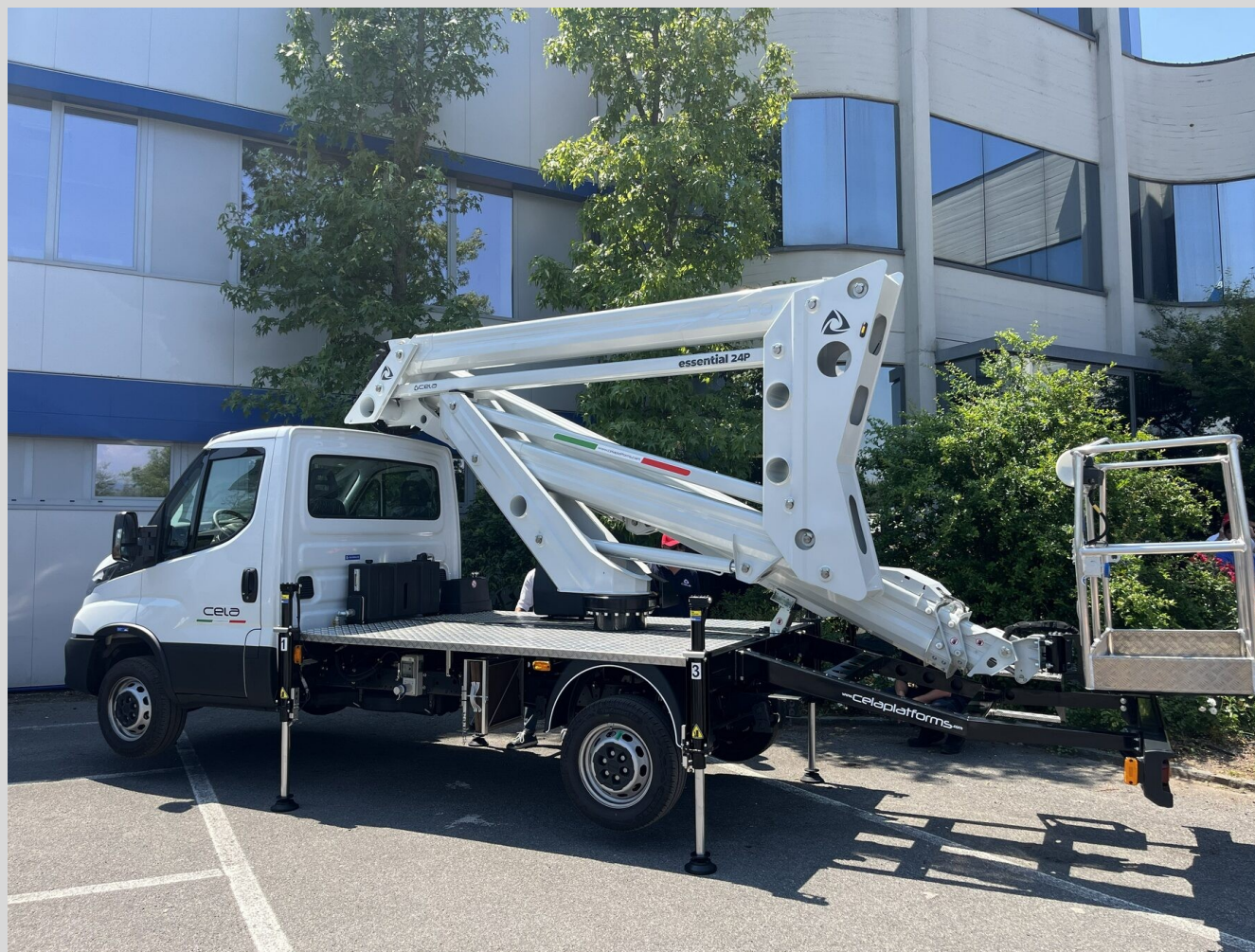
Cela Essential 24P: 24 m / 79 ft pracovní výšky z vozidla 3,5 t pro řidičský průkaz skupiny B
