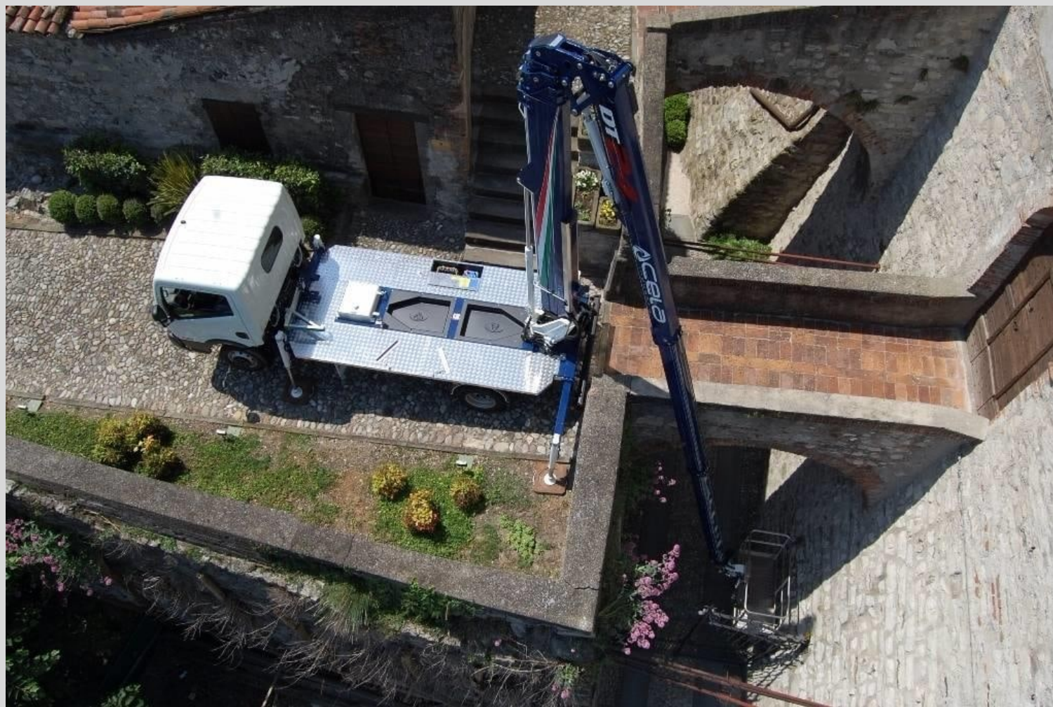
Půlkruhový pracovní diagram pro výjimečný dosah pod úroveň terénu
