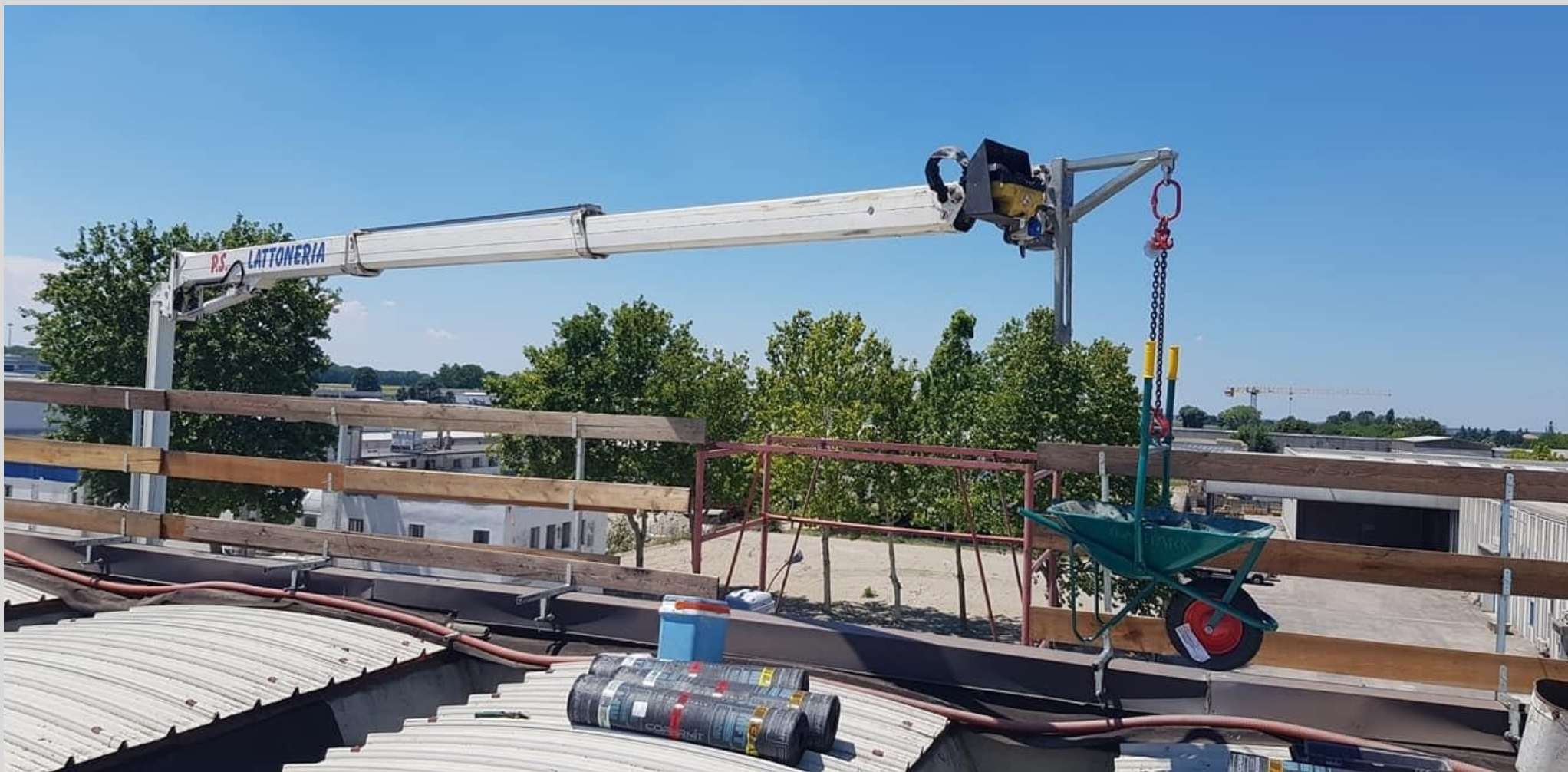
Plošiny CELA Advanced DT jsou certifikované jako pracovní plošiny i jako jeřáby
