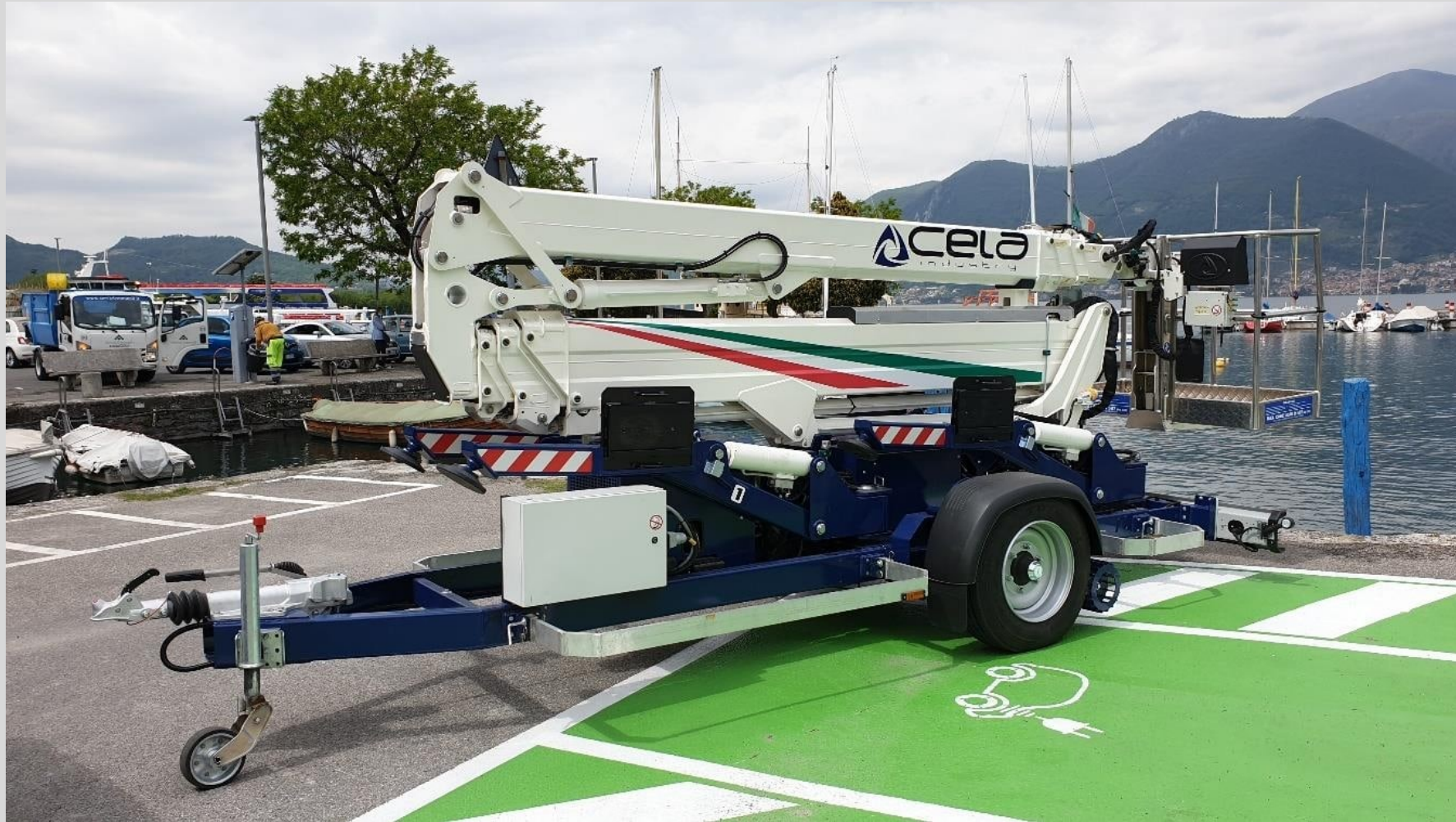
Der DT Trailer: auf der Straße gezogen, auf der Baustelle selbstfahrend
