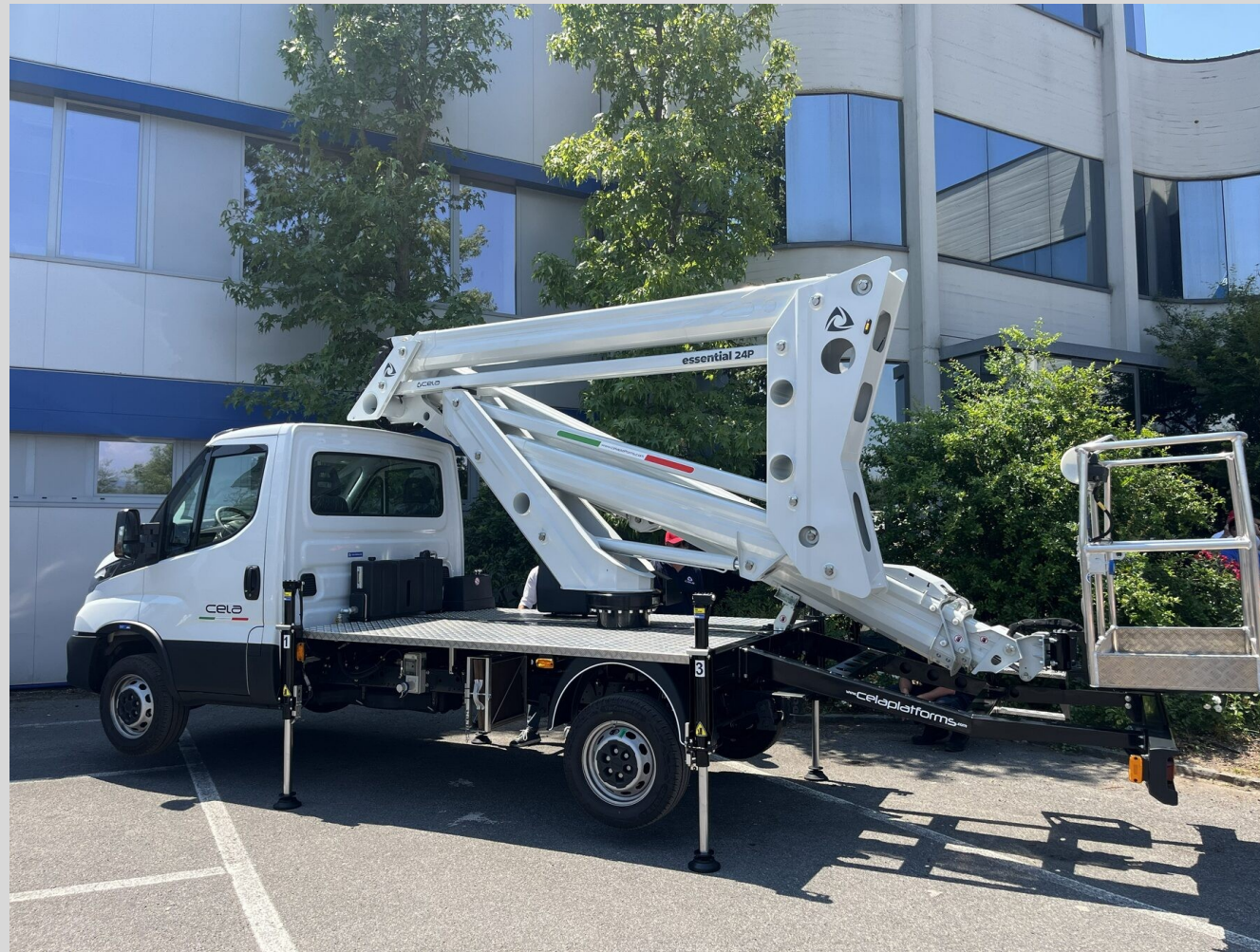
Cela Essential 24P: 24 m / 79 ft Arbeitshöhe auf einem 3,5-t-LKW, fahrbar mit Führerschein Klasse B
