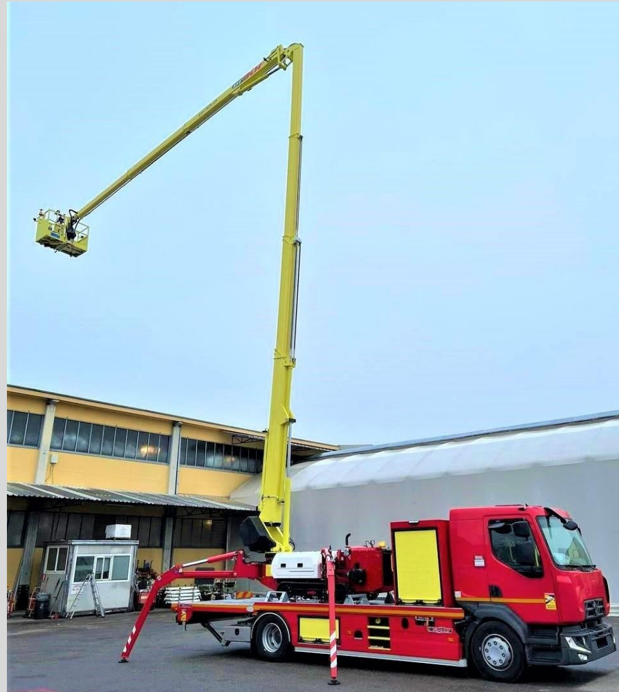
Feuerwehrtechnik 3 in 1: eine Feuerwehr-Raupenbühne, die auf einem LKW mitfährt und mit ihm oder allein arbeitet
