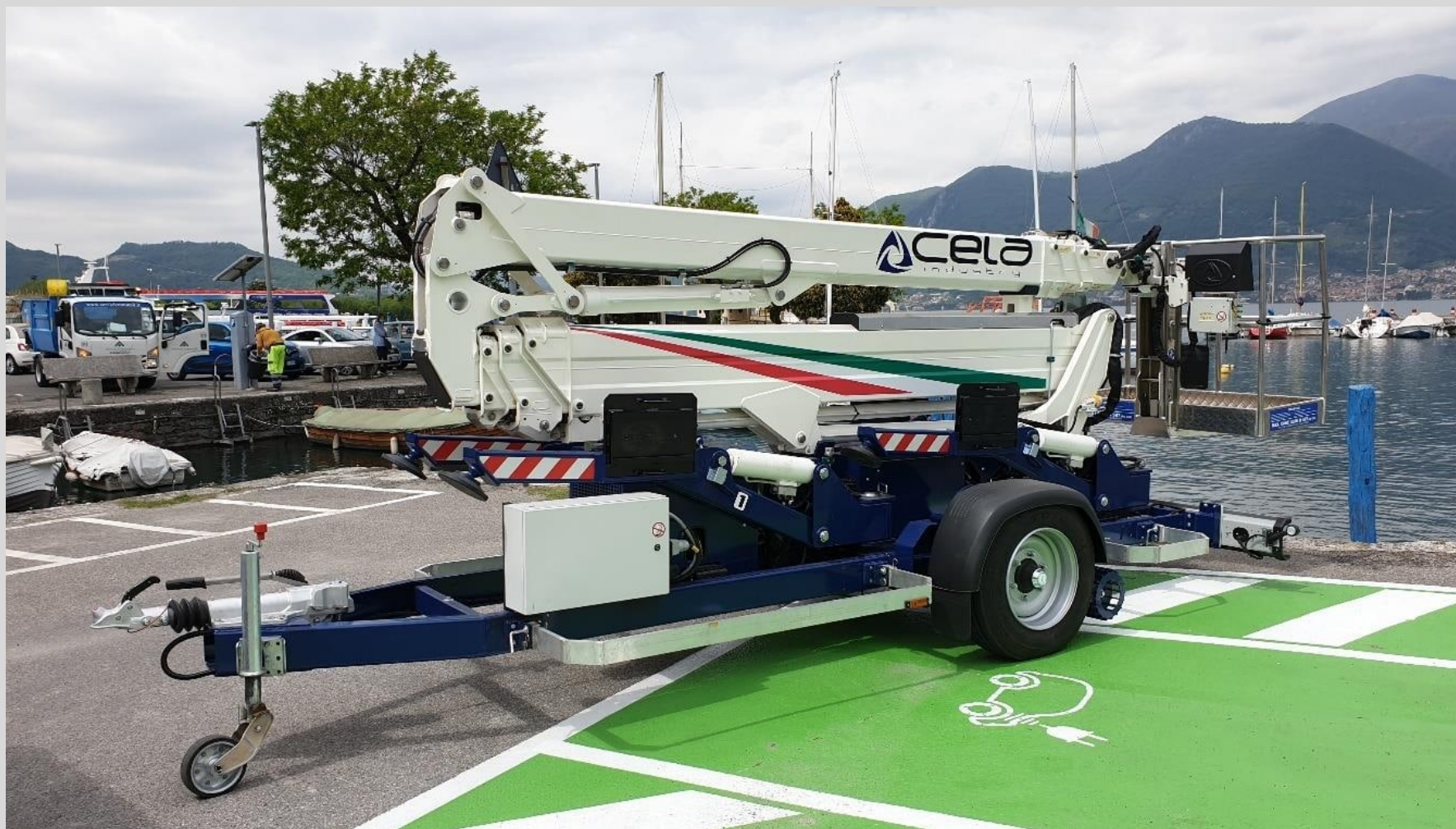
El DT Trailer: remolcable por carretera, autopulsado en obra
