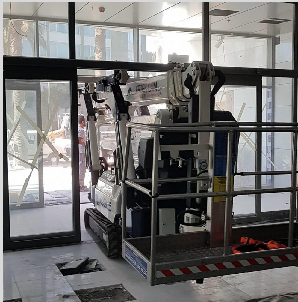
Les chenillées CELA Advanced DT sont assez étroites pour passer par la porte d'un bâtiment
