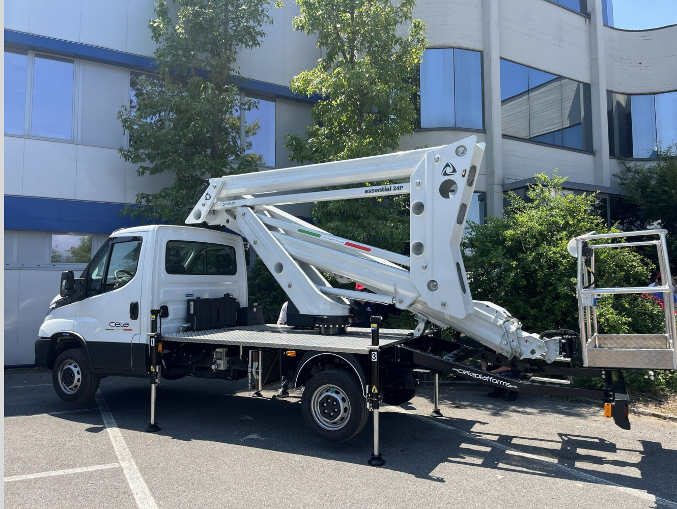
Cela Essential 24P: LMV लाइसेंस से चलने वाले 3.5 t ट्रक से 24 m / 79 ft कार्य ऊँचाई
