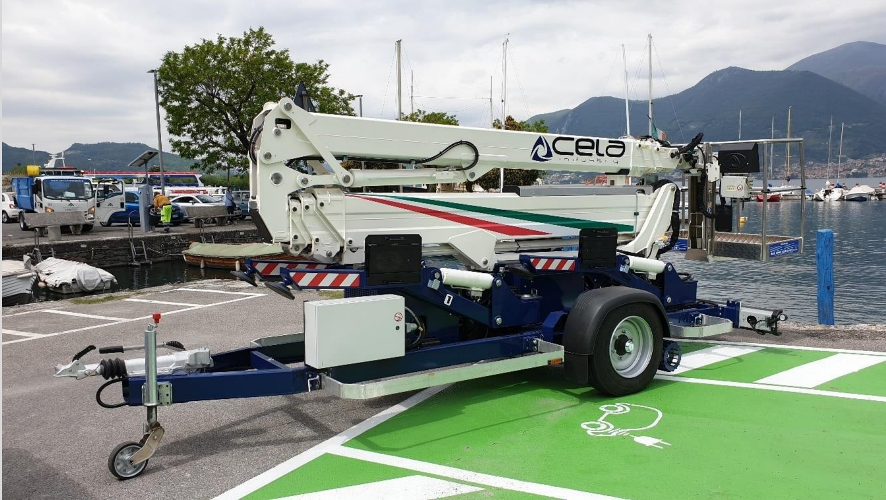
DT Trailer: सड़क पर टो करने योग्य, कार्यस्थल पर सेल्फ़-प्रोपेल्ड
