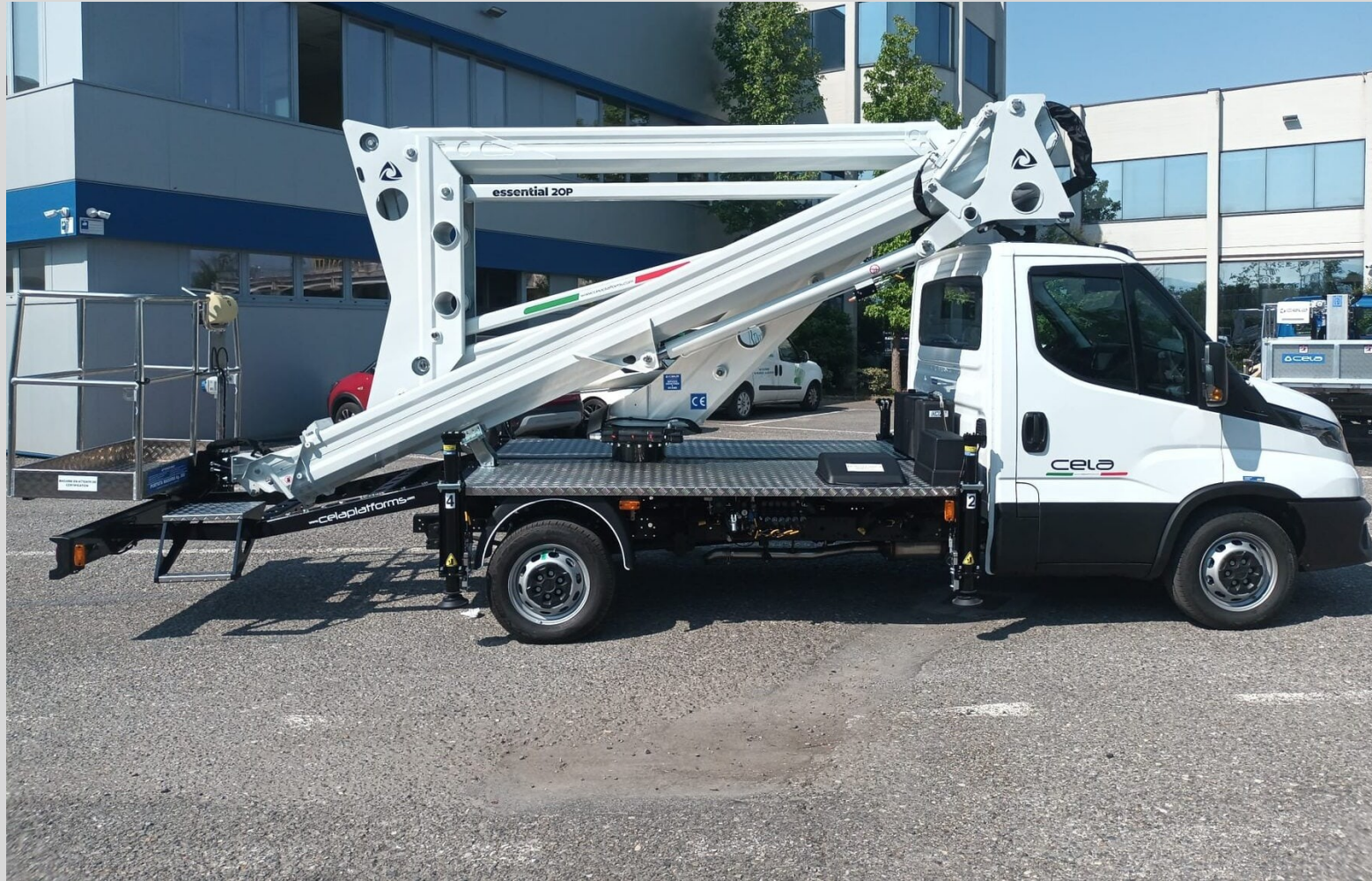
Cela Essential 20P: इमारतों के अग्रभाग पर up-and-over काम के लिए डबल पैटोग्राफ़, 9.5 m / 31 ft की up-and-over ऊँचाई
