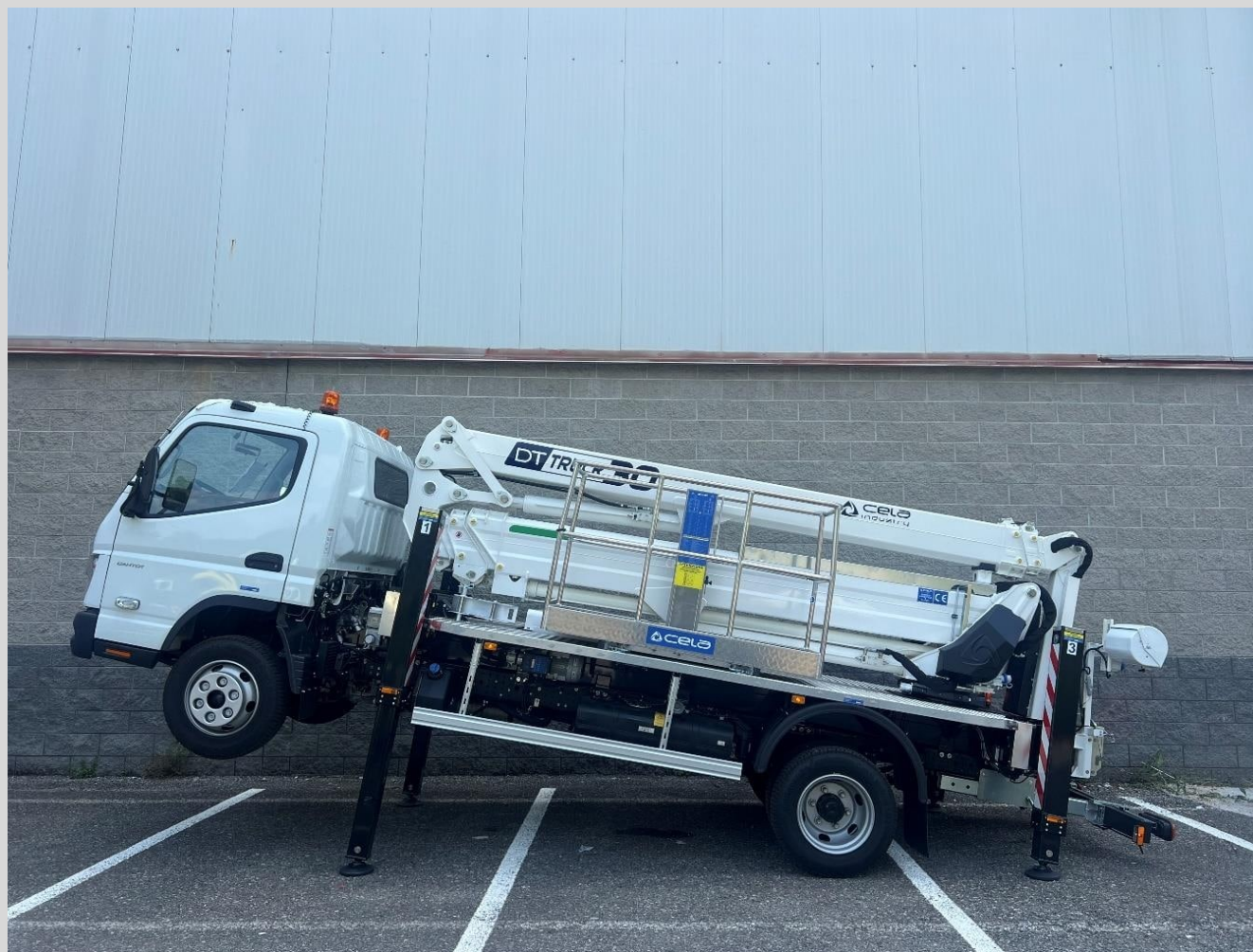
Outrigger tipe kotak memungkinkan DT Truck 30 distabilkan di lereng curam
