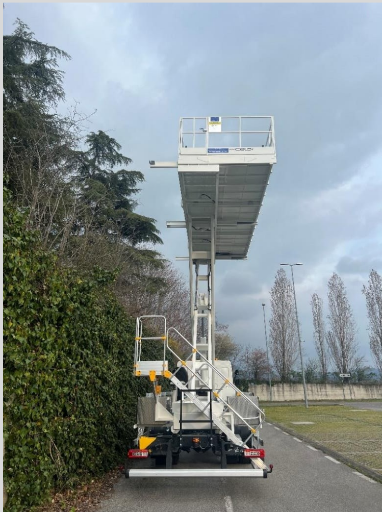
SC Truck: platform besar yang dapat bergeser dari sisi ke sisi
