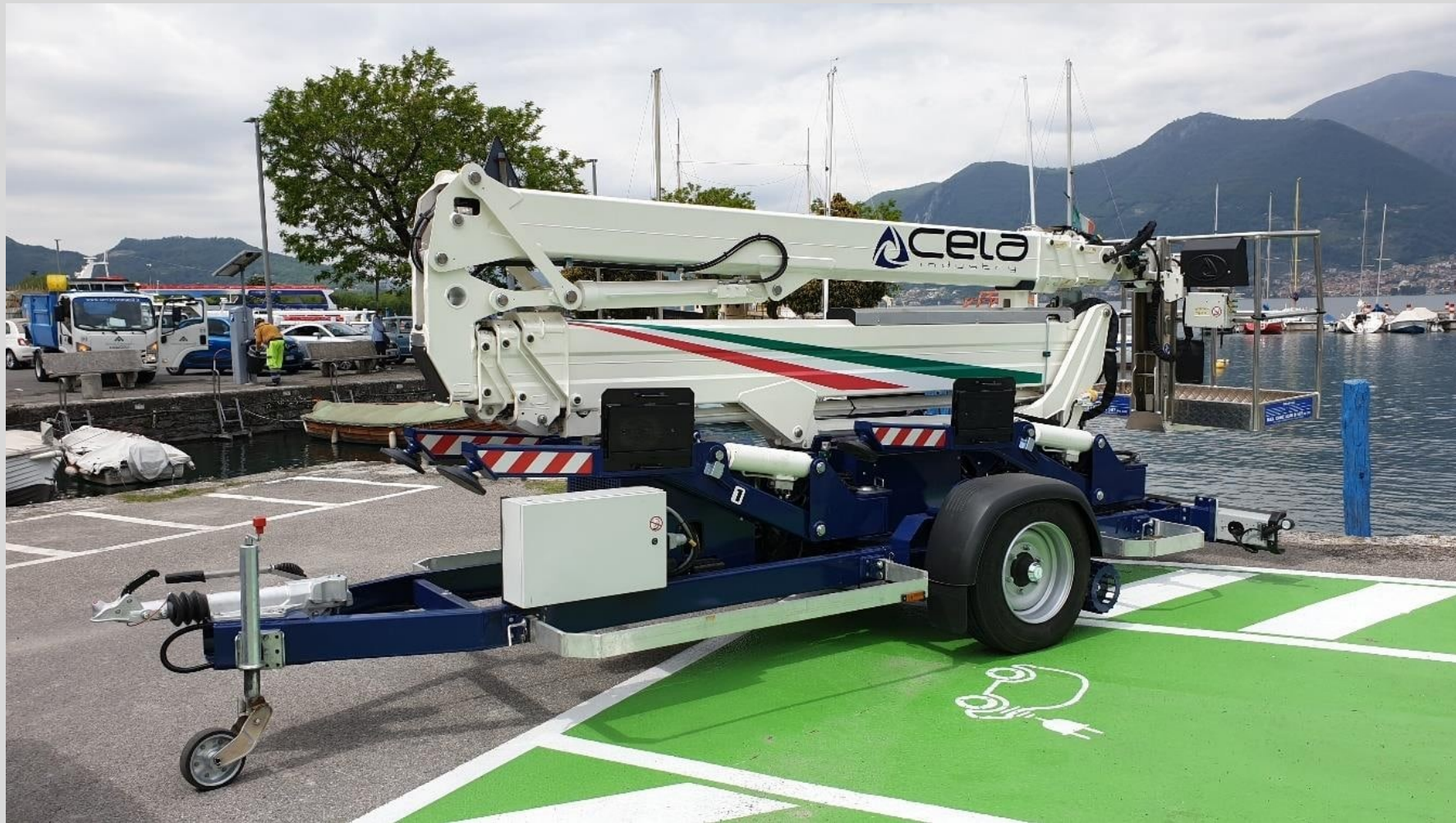
DT Trailer: dapat ditarik di jalan raya, bergerak sendiri di lokasi kerja
