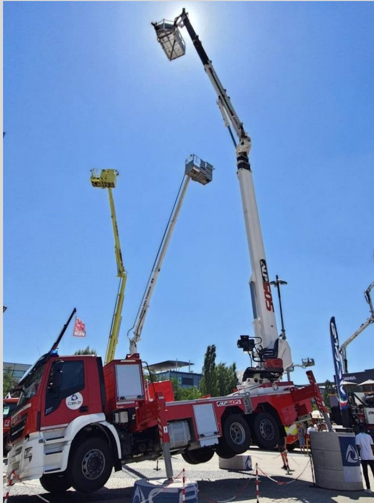
ALP 505: satu-satunya platform pemadam kebakaran di dunia yang dapat distabilkan pada kemiringan 15°
