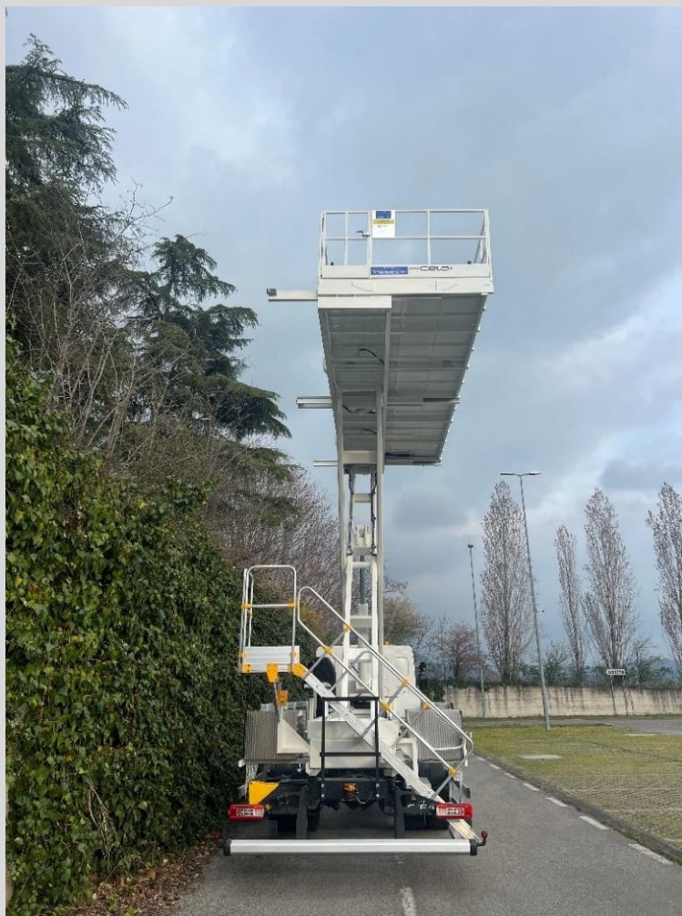
A SC Truck: uma grande plataforma que desliza de um lado para o outro
