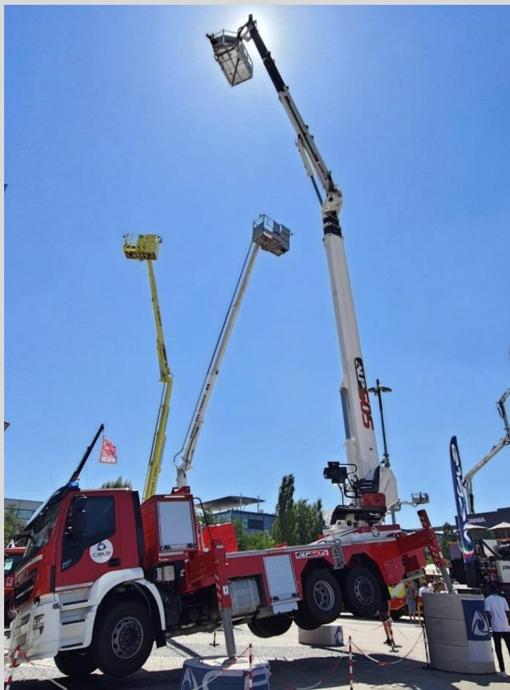
ALP 505: a única plataforma de combate a incêndios do mundo que estabiliza a 15°
