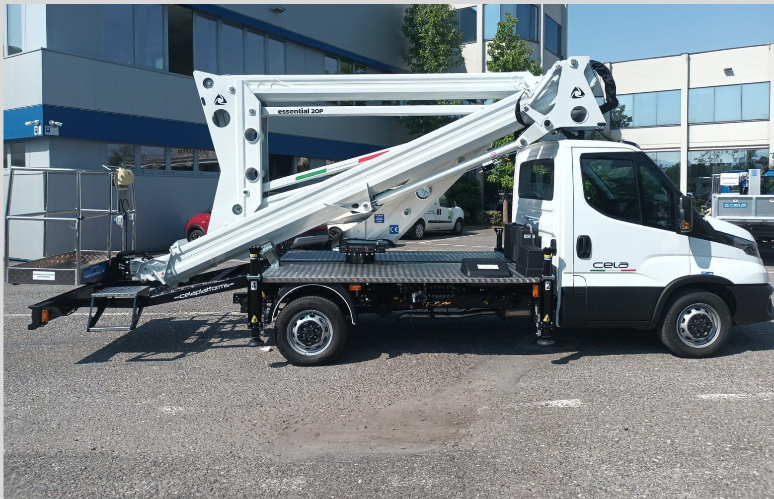
Cela Essential 20P: duplo pantógrafo para trabalhos up-and-over em fachadas, com 9,5 m / 31 ft de altura de transposição
